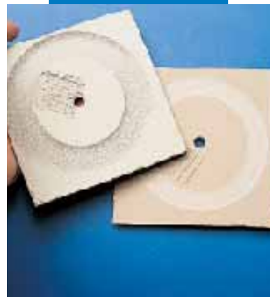
Δοκιμή τριβής κατά Taber στο Ultraplan (δείγμα δεξιά) και σε συμβατικό υλικό επιπέδωσης (δείγμα αριστερά) μετά από 200 κύκλους
