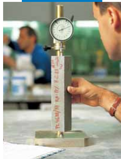
Προσδιορισμός διόγκωσης με περιορισμό σύμφωνα με το πρότυπο UNI 8147/80
